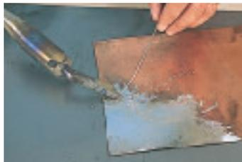
2. Chauffer la surface avec un fer de forte puissance et déposer de la soudure à l'étain. Étaler la soudure avec la panne du fer...
